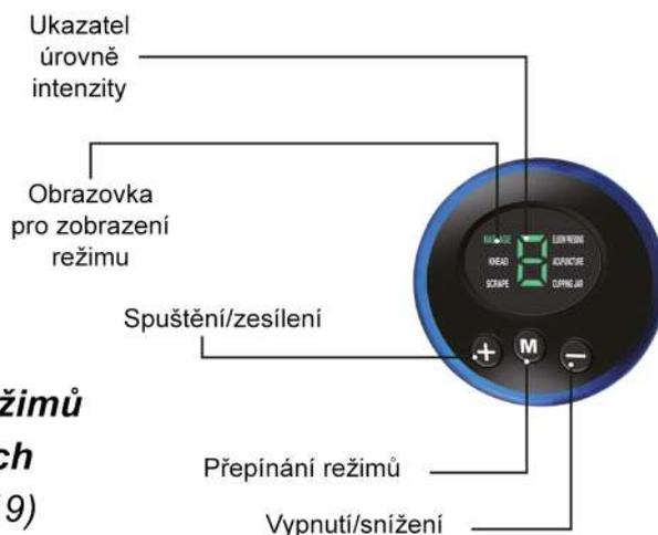
Když stiskne tlačítko "zapnutí" a "zvyšování intenzity", obrazovka se postupně zapne.
